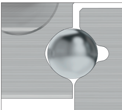
Gotisches Profil der Führungslaufbahnen
