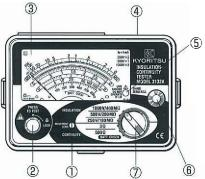
**\*\*DMETER MOVEMENT ZERO ADJUST @TEST BUTTON** (3)SCALE PLATE **4**INPUT CONNECTOR (5)LIVE CIRCUIT LAMP **6**OHMS ZERO ADJUST **PRANGE SELECTOR SWITCH**
