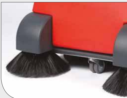
Der Bürstendruck der beiden Seitenbesen lässt sich werkzeuglos einstellen.
