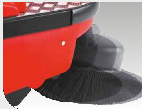
Die Seitenbesen weichen Hindernissen selbständig aus.
