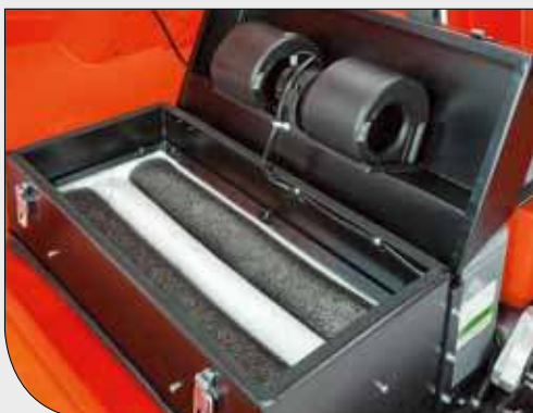
Der Taschenfilter ist einfach erreichbar und sorgt für ein staubfreies Kehren.
