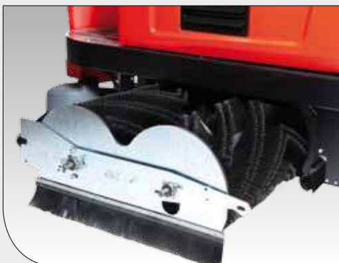
Werkzeugloser Bürstenwechsel in weniger als 3 Minuten.
