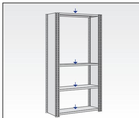
Die Stahlfachböden, unten beginnend, in die Längsriegel, bzw. die Fachbodenträger, einhängen.
