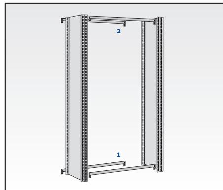
Die vormontierten Rahmen aufrichten und zuerst als unterste Fachebene, dann als oberste Fachebene jeweils mit zwei Längsriegeln verbinden.
