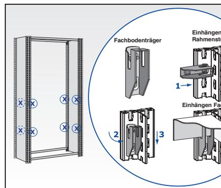
Für die beiden weiteren Fachebenen / zur Aufnahme der Stahlfachböden je 4 Fachbodenträger auf gleicher Höhe in die Rasterlochung einhängen.
