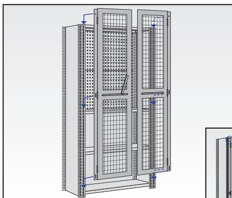
Beide Türen mit den Anschlagleisten in die Rasterlochung der Rahmenstützen einhängen
