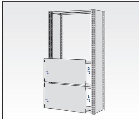
Die beiden Rückwände Vollblech, unten beginnend, auf der Regalrückseite in die Rasterlochung der Rahmenstütze einhängen.
