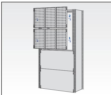
Anschließend die beiden Rückwände Lochblech, unten beginnend, in die Rasterlochung der Rahmenstütze einhängen.
