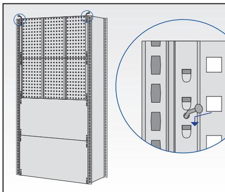
Die obere Rückwand Lochblech, jeweils rechts und links, am oberen Ende mit Sicherungstift gegen Ausheben sichern.
