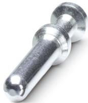
Crimpkontakt, Kontaktdurchmesser: 4 mm, gedreht, Stift, Material Kontakt: Kupferlegierung, bleifrei, Kontaktoberfläche: versilbert, Anschlussquerschnitt: 1,5 mm<sup>2</sup> ... 1,5 mm<sup>2</sup>, AWG 16
