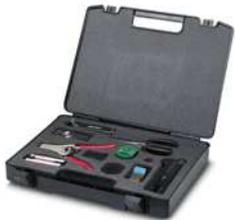
HCS-Konfektionierungskoffer für SC-RJ-Schnellmontagestecker, beinhaltet Abisoliermesser, Abisolierzange, Aramidgarnschere, Faserstripper, Mikroskop, Faserritzwerkzeug für Standard-HCS- sowie HCS-GI-Fasern, zwei SC-RJ-Stecker für Standard-HCS-Faser und Dokumentation
