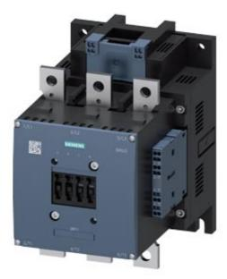
Leistungsschütz, AC-3 265 A, 132 kW / 400 V AC (50-60 Hz) / DC-Betätigung UC 240-277 V Hilfskontakte 2 NO + 2 NC 3-polig, Baugröße S10 Schienenanschlüsse Antrieb: konventionell Federzuganschluss
