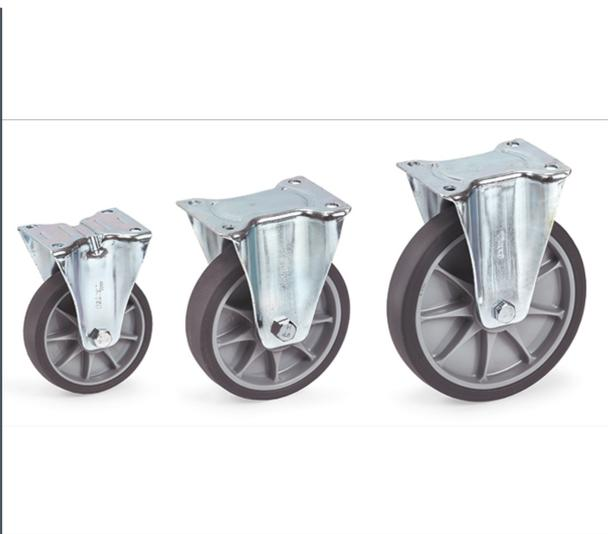
125 x 32 mm. Armature en tôle d'acier galvanisée. Roue à bandage TPE (Élastomère thermoplastique) équipée de pare-fils, moyeu à roulement à billes de précision. Déplacement silencieux sur sols plats, peu de résistance au déplacement et à la rotation. Bandage non traçant.
