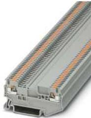
Durchgangsreihenklemme, konturgleich zur Trennklemme, Nennspannung: 400 V, Nennstrom: 17,5 A, 1. Etage, Anschlussart: Push-in-Anschluss, Bemessungsquerschnitt: 1,5 mm<sup>2</sup>, Querschnitt: 0,14 mm<sup>2</sup> - 1,5 mm<sup>2</sup>, Montage: NS 35/7,5, NS 35/15, Farbe: grau
