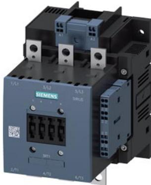
Leistungsschütz, AC-3 115 A, 55 kW / 400 V AC (50-60 Hz) / DC-Betätigung AC/DC 440-480 V Hilfskontakte 2 NO + 2 NC 3-polig, Baugröße S6 Schienenanschlüsse Antrieb: konventionell Federzuganschluss
