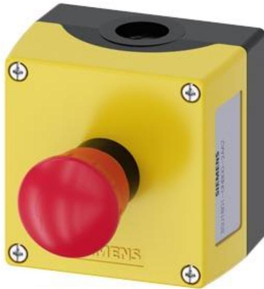
Gehäuse für Befehlsgeräte, 22 mm, rund, Gehäusematerial Kunststoff, Gehäuseoberteil gelb, 1 Befehlsstelle Kunststoff, Befehlsstelle mittig, A=NOT-HALT-Pilzdrucktaster rot, 40 mm, drehentriegelt, 1Ö, 1Ö, Schraubanschluss, Bodenbefestigung, oben und unten je 1xM20
