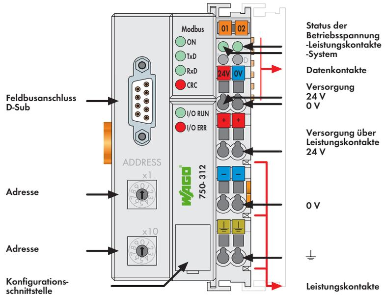
Dieser Feldbuskoppler verbindet das WAGO-I/O-SYSTEM als Slave mit dem MODBUS oder Feldbus.
