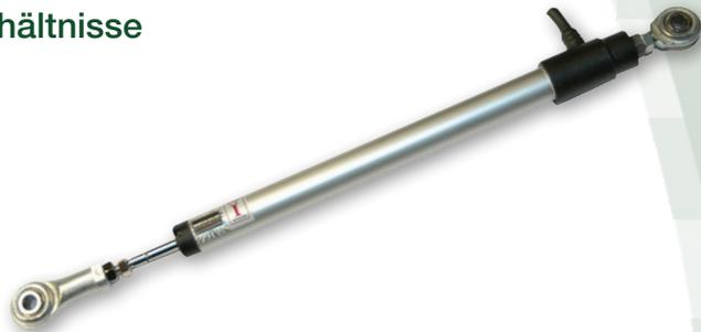
Der PZ12A Wegaufnehmer ist in 7 Hublängen für direkte absolute Messung von 10 mm bis 150 mm verfügbar. Dieses Design ist insbesondere geeignet für die Montage in Bereichen mit eingeschränktem Platzangebot. Eine verbesserte Technik zum Herstellen der Verbindung zur Widerstandsbahn (Double Trimming Technique) sorgt für einen hohen Grad an Zuverlässigkeit und Linearität, während Multi-Finger-Schleifer auch unter widrigsten Arbeitsbedingungen eine gute Ausgangssignalstabilität sicherstellen.
