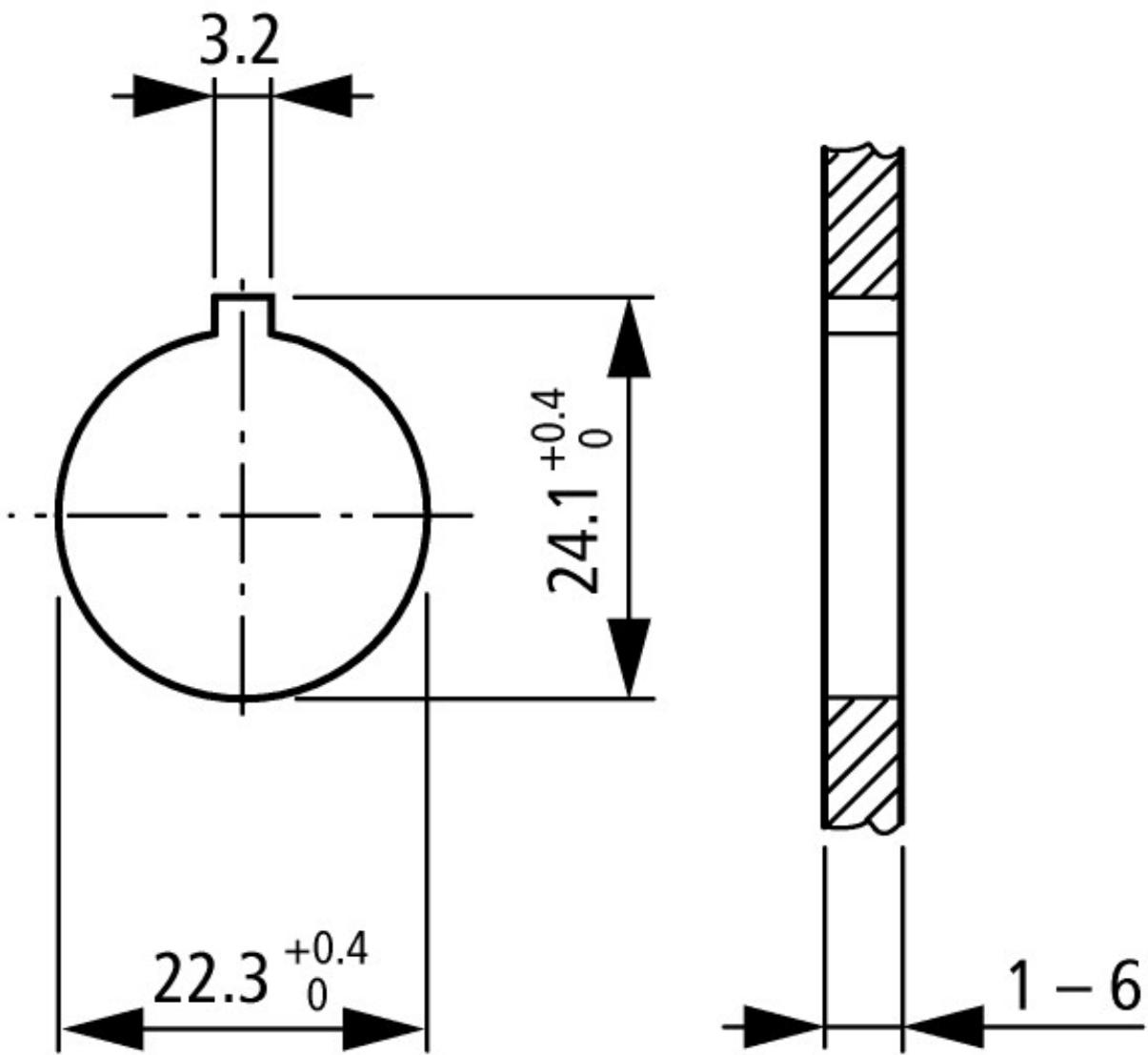
Einbaubohrung mit Nasenausschnitt
