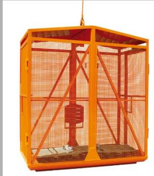
Für zwei Personen, den Verletzten in der Trage und den Versorger. Die beiden Türen an den Schmalseiten des allseits geschlossenen Korbes gewährleisten einen gleichzeitigen Ein- und Ausstieg des Ersthelfers mit der Trage aus dem Rettungskorb, an seinem offenem Ende; mit einer gefederten Zugöse, 1,40 m langen Seilstrupp. Entspricht den arbeitssicherstechnischen Bestimmungen der Berufsgenossenschaften und den Sicherheitsregeln für hochziehbare Personenaufnahmemittel. (PAM; GS)
