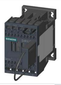
CONT. F. RAILW. A., AC-3, 5.5KW 400V, DC 24V, 0,7...1,25\*US, VARISTOR INTEGRATED, 3-POLE, SZ S00 SPRING-LOADED TERMINAL
