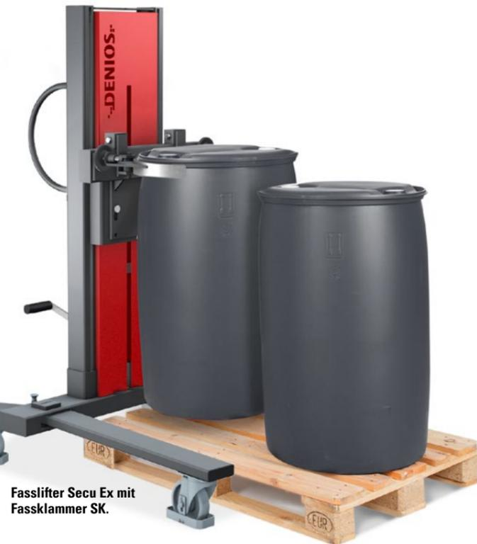
Fasslifter Secu Ex mit Fassklammer SK.
