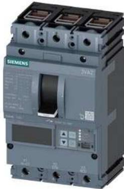
Leistungsschalter 3VA2 IEC Frame 100 Schaltvermögenklasse H Icu=85kA @ 415V 3-polig, Anlagenschutz ETU860, LSIG, In=25A Überlastschutz Ir=10A...25A Kurzschlusschutz Isd=0,6..10x In, li=1,5..12x In N-Leiterschutz optional mit externem Stromwandler, bis 160% Erdschlussschutz, abschaltbar Ig=0,2...1 x In, tg=0,05-0,8s Klemmenanschluss
