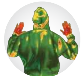
KLEENGUARD* A45 Schutzanzug Der Temperaturanstieg ist weitaus geringer und viel gleichmäßiger verteilt. Die körperliche Belastung für die Person ist wesentlich geringer.
