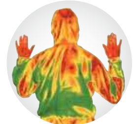
Herkömmlicher Schutzanzug nach 10 Minuten körperlich anstrengender Arbeit.
