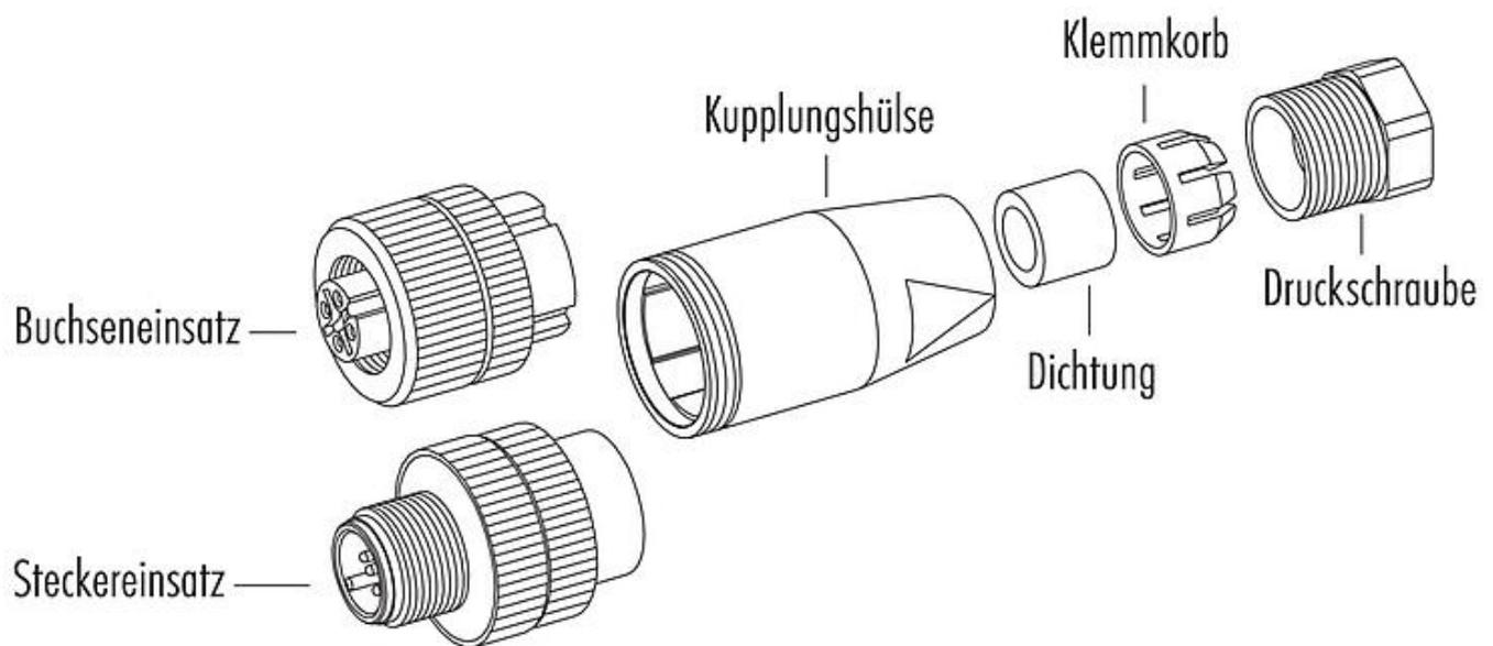
Material der Gewindinge: Kunststoff, Zink Druckguss, Edelstahl
