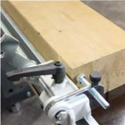
Das 3 Meter lange Anschlagprofil mit mm-Skala sowie der Längenanschlag ermöglichen präzises Positionieren der Werkstücke.
