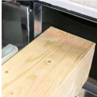
Die neue Lasertechnik ermöglicht Ihnen, das Werkstück nach Anriss zu positionieren.
