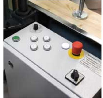
Übersichtlich und klar angeordnet - die Bedienelemente der ZAF 250 Vario für Automatik- oder Handbetrieb.
