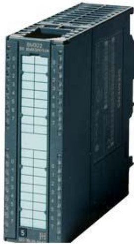
SIMATIC S7-300, DIGITALAUSGABE SM 322 HIGH SPEED, POTENTIALGETRENNT, 16DA, DC24V, 0,5A, 1 X 20-POLIG
