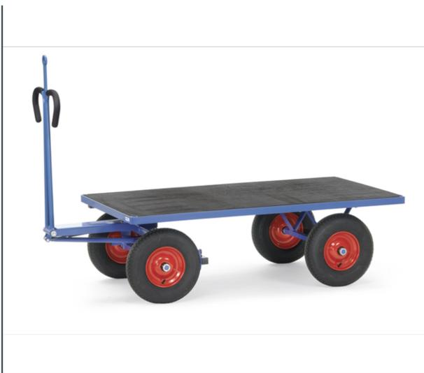
Baukasten-System: Aus Profilstahl geschweißt, pulverbeschichtet blau RAL 5007, 4 Eckhülsen. Drehschemel-Lenkung mit Kugelkranz, Scherendeichsel mit Sicherheits-Handgriff mit Softgrip-Bezug und automatischer gedämpfter Rückstellung in Ruheposition. Ladefläche belegt mit rutschsicherer Siebdruckplatte aus wasserfestem Sperrholz. Räder wahlweise mit Vollgummi- oder Luft-Bereifung, Naben mit Rollenlager. Automatische Feststellbremse auf die Vorderräder wirkend, entspricht EN 1757-3.
