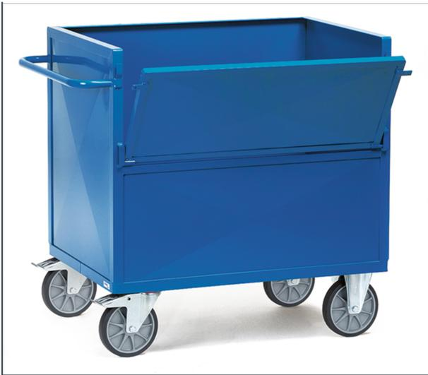
Stahlrohr und Profilstahl geschweißt, pulverbeschichtet blau RAL 5007. Boden aus Stahlblech, pulverbeschichtet. Winkelstahl-Konstruktion. Wände aus gesicktem Stahlblech, eingeschweißt, pulverbeschichtet. 2 Lenk- und 2 Bockrollen, TPE-Bereifung, Naben mit Rillenkugellager. Feststeller an den Lenkrollen, gemäß der Europäischen Norm EN 1757-3 (Sicherheit von Plattformwagen). Zerlegte Anlieferung. Nutzhöhe: 816 mm.
