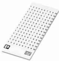
Kennzeichnungskarte, weiß, beschriftet, längs: fortlaufende Zahlen 1 ... 10, 11 ... 20 usw. bis 91 ... 99, Montageart: kleben, für Klemmenbreite: 3,5 mm, Schriftfeldgröße: 3,5 x 2,8 mm
