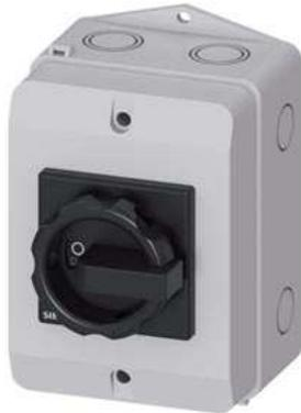
SENTRON, Lasttrennschalter 3LD, Hauptschalter, 3-polig, I<sub>n</sub>: 25 A, Betriebsleistung / bei AC-23 A bei 400V: 9,5 kW, Isolierstoff-Kapselung für metrische Verschraubung, Drehantrieb, schwarz
