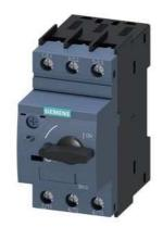
Leistungsschalter Baugröße S0 für den Motorschutz, CLASS 10 A-Auslöser 1,8...2,5 A N-Auslöser 33 A Schraubanschluss Standardschaltvermögen
