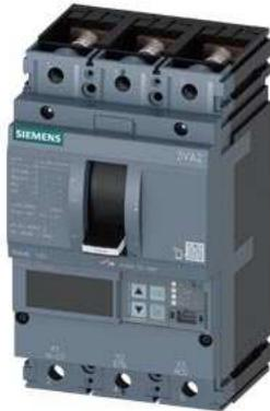
Leistungsschalter 3VA2 IEC Frame 100 Schaltvermögenklasse H Icu=85kA @ 415V 3-polig, Anlagenschutz ETU850, LSI, In=40A Überlastschutz Ir=16A...40A Kurzschlusschutz Isd=0,6..10x In, li=1,5..12x In N-Leiterschutz optional mit externem Stromwandler, bis 160% Schraubenflachanschluss
