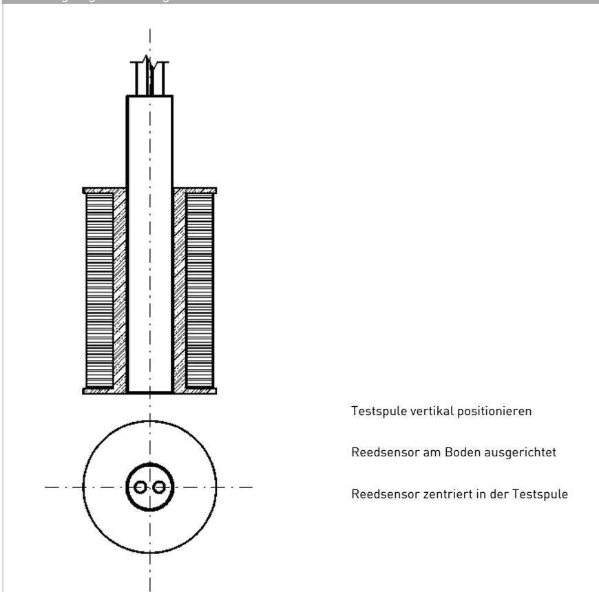
Testspule vertikal positionieren
