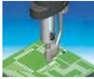
Reinigung der Leiterpads mit dem Entlötkolben
