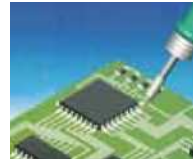
Löten zweier gegenüberliegender Ecken des Bauteils mit dem LötKolben
