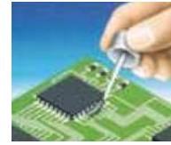
Aufbringen des Flussmittels auf die Pads und Leads des ICs
