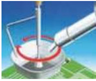
Entlöten des IC-Bauteils mit Heißluft
