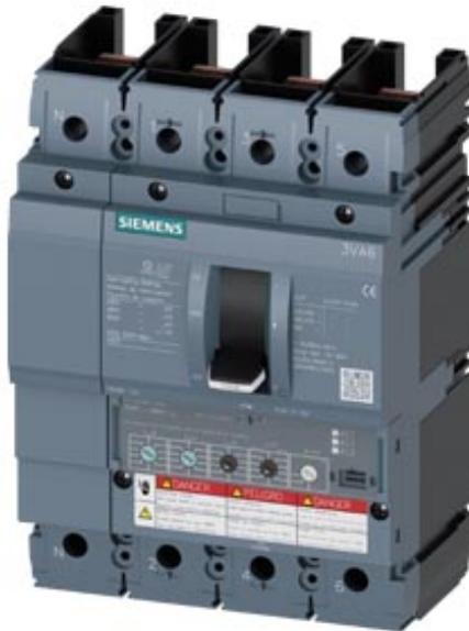
Leistungsschalter 3VA6 UL Frame 150 Schaltvermögenklasse E 200 kA @ 480 V 4-polig, Anlagenschutz ETU330, LIG,  $I_n=60A$
