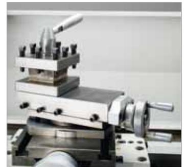
Drehbarer Oberschlitten für das Kegeldrehen
