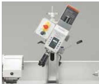
Fräskopf Schwenkbereich ± 90°
