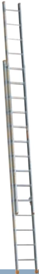
Zweiteilige Schiebeleiter für größere Höhen, mit kurzen Transport- und Lagermaßen. Sprossenweise manuelle Längeneinstellung durch Aufsetzhaken, Sicherung gegen Ausheben und Ausschieben, Ober- und Unterleiter getrennt verwendbar.
