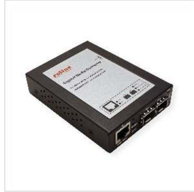
**Zur Anpassung von unterschiedlichen Verkabelungen innerhalb eines LAN können LWL-Konverter eingesetzt werden um ein funktionales Netzwerk zu erhalten. Ob zur Umsetzung von LWL auf ein klassisches Twisted Pair-Netz mit einem Mini-GBIC oder zur Umsetzung von LWL auf ein anderes LWL-Netz mit zwei Mini-GBICs. Der ROLINE GigaBit Konverter bietet beide Möglichkeiten.**
