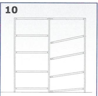
Ansetzen weiterer Anbaufelder nach Bedarf und nach dem Ausrichten mit dem Grundregal fest verschrauben, Einsatz von Eckwinkeln gem. Abb. 11.
