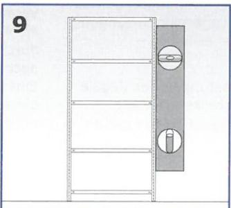
Aufrichten des Regalfeldes und am Aufstellort mit Wasserwaage ausrichten. **Achtung:** Erst jetzt die Schrauben der Eckwinkel festziehen, sonst ist das Ausrichten des Regalfeldes „ins Wasser“ nicht mehr möglich!
