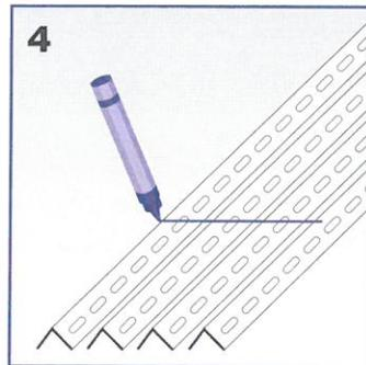
Es wird empfohlen vor Montagebeginn die Winkelprofile für die geplanten Fachhöhen mit einem Filzstift zu kennzeichnen. Das erleichtert die weiteren Montageschritte.
