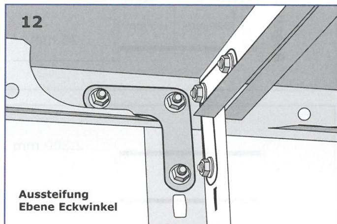
Einbau der Böden/Zwischenböden mit Schrauben/Muttern, sowie der entsprechenden Anzahl Eckwinkeln zur fachgerechten Aussteifung je nach Regalhöhe gemäß der Abb. 11 durchführen.
