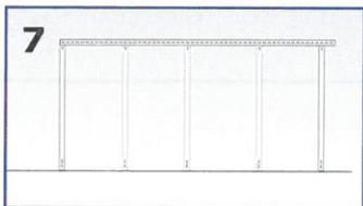
Einbau der Zwischenböden mit Schrauben/Muttern, sowie der entsprechenden Anzahl Eckwinkeln zu Aussteifung je nach Regalhöhe. Siehe Angaben Abb. 11.
