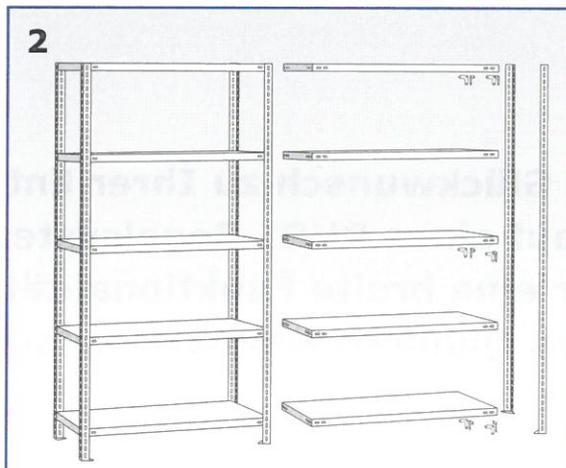
Ansetzen weiterer Anbaufelder nach Bedarf und nach dem Ausrichten mit dem Grundregal fest verschrauben, Einsatz von Eckwinkeln oder Schrauben je nach Anzahl der Fachböden, gemäß Abb. 11.
