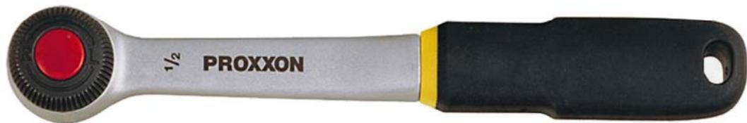
Mit Umschaltfunktion direkt auf dem Ratschenmechanismus. Mehrere der 52 Zähne rasten gleichzeitig ein und übertragen extrem hohe Drehmomente. Entriegelungs-Mechanismus: Lösen der Einsätze durch Knopfdruck. Kopf und Schaft aus einem Stück CrV-Stahl geschmiedet, 2x vernickelt und matt-verchromt. Griff aus öl- und säurefestem TPR (Thermoplastic Rubber) mit praktischer Bohrung zum Aufhängen.
