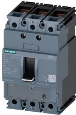
Leistungsschalter 3VA1 IEC Frame 160 Schaltvermögenklasse H Icu=70kA @ 415V 3-polig, Starterschutz TM120M, AM, In=32A ohne Überlastschutz Kurzschlusschutz Ii=7...16 x In Schraubenflächanschluss
