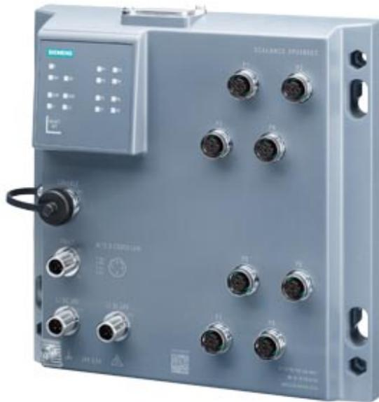
SCALANCE XP208EEC, managed IE Switch mit Bahn-Zulassung IEC 62443-4-2 zertifiziert; (EN 50155, EN 45545); 8x 10/100 Mbit/s M12 Ports, IP65, LED-Diagnose, Fehler-Meldekontakt, redundante Spannungsversorgung, PROFINET IO Device, Netzwerk-Management, im redundanten Ring betreibbar, Staubschutzkappen, inkl. elektron. Handbuch auf CD-ROM, C-PLUG optional
