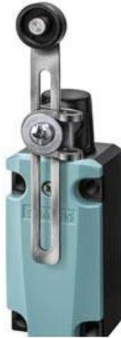
SIRIUS POSITIONSSCHALTER METALLGEHAEUSE 40MM, NACH EN50041 GERAETEANSCHLUSS 1X (M20X1,5) 1S/10E SCHLEICHKONTAKTE SCHWENKANTRIEB RECHTS/INLKS EINSTELLBAR, MIT LAENGEN- VERSTELLB. METALLHEBEL 100MM LANG UND KUNSTSTOFFROLLE 19MM
