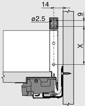
Schließkasten-Frontstück vorbohren Ø 2.5 mm
