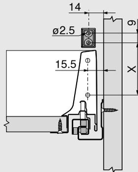
Schließkasten-Frontstück vorbohren Ø 2.5 mm
