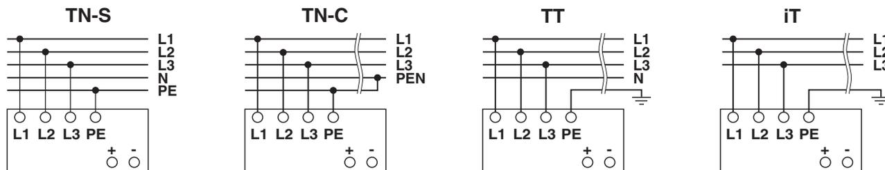
Il collegamento per 3x 400 V AC ... 500 V AC avviene mediante le connessioni a vite L1, L2, L3 e PE. L'apparecchio può essere collegato a sistemi trifase di corrente alternata con tensioni nominali di 3x 400 V AC ... 500 V AC. Nel caso di guasto di una fase, il funzionamento è garantito con la potenza nominale. Anche il funzionamento bifase in sistemi a corrente alternata e a reti DC è illimitato.
