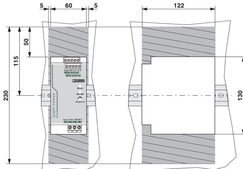
Posizione di montaggio compatta: Ingombro compatto 125 mm (+ guida di supporto) (impostazioni di fabbrica)
