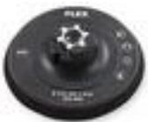
Schleifteller mit Klettbelag Bowl zur Befestigung der Schleifmittel mit Klett-System. 12 mm Zellkautschuk sorgen als Dämpfungselement für eine gleichmäßige Druckverteilung.
