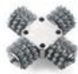
Bestückt mit 12 spitzen Hartmetall Fräsrädern. Zum Entfernen von hartem Putz, Beton, Schaumrücken und Kleberresten, Farbanstrichen auf Putz, Kunstharzputz, elastischen Schutzanstrichen, Putz auf Holzbalken und Latex-/Ölfarben auf Putz. Der Untergrund wird durch die spitze Form aufgeraut.
