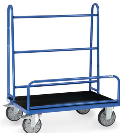
Ensemble mécano-soudé, revêtement époxy bleu RAL 5007. Plateforme en mélaminé surface avec revêtement caoutchouc. Armature en tôle d'acier à boulonner. 2 roues fixes et 2 roues pivotantes à bandage TPE, moyeu à roulement à billes. Freins sur roues pivotantes. Hauteur utile : 1 050 mm. Hauteur du tube cintré d'arrêt : 300 mm.
