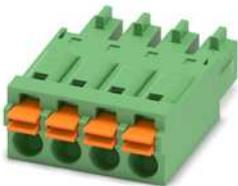
Leiterplattenstecker, Nennquerschnitt: 1,5 mm<sup>2</sup>, Farbe: grün, Nennstrom: 8 A, Bemessungsspannung (III/2): 160 V, Kontaktoberfläche: Zinn, Kontaktart: Buchse (female), Anzahl der Potenziale: 4, Anzahl der Reihen: 1, Polzahl: 4, Anzahl der Anschlüsse: 4, Artikelfamilie: FMC 1,5/..-ST, Rastermaß: 3,81 mm, Anschlussart: Push-in-Federanschluss, Anschlussrichtung Leiter/Platine: 0 °, Stecksystem: COMBICON MC 1,5, Verriegelung: ohne, Befestigungsart: ohne, Verpackungsart: verpackt im Karton
