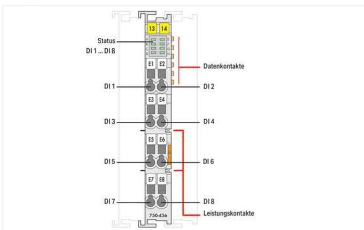
Das Digitaleingangsmodul verfügt bei nur 12 mm Baubreite über 8 Kanäle. Es erfasst Steuersignale aus dem Feldbereich, z.B. über Sensoren. Zur Störunterdrückung ist jedem Eingang ein Filter vorgeschaltet. Feld- und Systemebene sind galvanisch getrennt.
