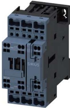
Leistungsschütz, AC-3 25 A, 11 kW / 400 V 1 S + 1 Ö, AC 24 V, 50 Hz, 3-polig, Baugröße S0 Federzuganschluss für stehende Einbaulage
