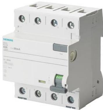
FI-Schutzschalter, 4-polig, Typ A, In: 40 A, 300 mA, Un AC: 400 V
