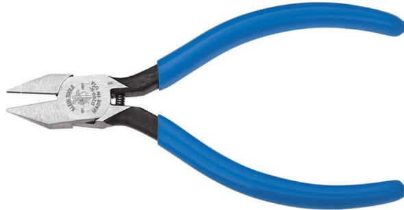
Spitze Nase für präzises Schneiden und Trimmen von Leiterplatten. Federbelastet zur Selbstöffnung. Kurze Backen und abgeschrägte Schneidkanten erlauben kurze Schnitte. Induktionsgehärtete Messerklingen sorgen für Langlebigkeit. Warm genietetes Scharnier sorgt für reibungslose Arbeit ohne Wackeln der Griffe. Kunststoff-getauchte Griffe zur bequemen Handhabung und leichten Erkennung. Werkzeug-Spezialstahl, Made in USA.
