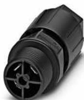
Wanddurchführung, QUICKON-Anschluss, Polzahl: 2+PE, 0,5 mm<sup>2</sup> ... 1,5 mm<sup>2</sup>, 690 V, 15 A, schwarz, mit QUICKON-Mutter, Leitungsaußendurchmesser: 5 mm ... 9,5 mm, Montagegewinde: M20, Flachsteckanschluss (für Flachsteckhülsen nach DIN 46247-2), 1,5 mm<sup>2</sup>
