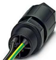
Wanddurchführung, QUICKON-Anschluss, Polzahl: 2+PE, 0,5 mm<sup>2</sup> ... 1,5 mm<sup>2</sup>, 690 V, 17,5 A, schwarz, mit QUICKON-Mutter, Leitungsaußendurchmesser: 5 mm ... 9,5 mm, Montagegewinde: M20, Einzeladern, 1,5 mm<sup>2</sup>, Leitungslänge: 1 m
