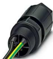
Wanddurchführung, QUICKON-Anschluss, Polzahl: 2+PE, 0,5 mm<sup>2</sup> ... 1,5 mm<sup>2</sup>, 690 V, 17,5 A, schwarz, mit QUICKON-Mutter, Leitungsaußendurchmesser: 5 mm ... 9,5 mm, Montagegewinde: M20, Einzeladern, 1,5 mm<sup>2</sup>, Leitungslänge: 0,5 m
