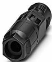
Leitungsverbinder, QUICKON-Anschluss, Polzahl: 2+PE, 0,5 mm<sup>2</sup> ... 1,5 mm<sup>2</sup>, 690 V, 17,5 A, schwarz, mit einer QUICKON-Mutter, Leitungsaußendurchmesser : 5 mm ... 9,5 mm, QUICKON-Schnellanschluss
