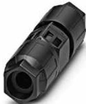
Leitungsverbinder, QUICKON-Anschluss, Polzahl: 2+PE, 0,5 mm<sup>2</sup> ... 1,5 mm<sup>2</sup>, 690 V, 17,5 A, schwarz, mit zwei QUICKON-Muttern, Leitungsaußendurchmesser: 5 mm ... 9,5 mm, QUICKON-Schnellanschluss
