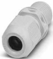
Kabelverschraubung, Material Verschraubung: PA, Kabelaußendurchmesser 4,5 mm ... 10 mm, Schirmung: nein, Anschlussgewinde: M16 x 1,5, Farbe: lichtgrau RAL 7035
